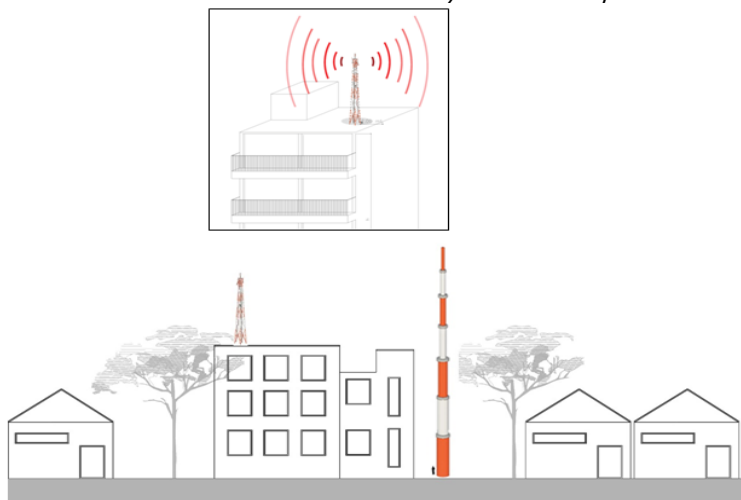
Ilustración 3. Estructura en azotea y torre auto soportada
