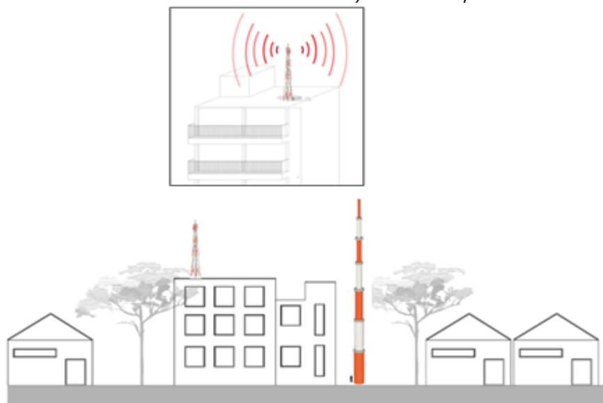
Ilustración 3. Estructura en azotea y torre auto soportada
