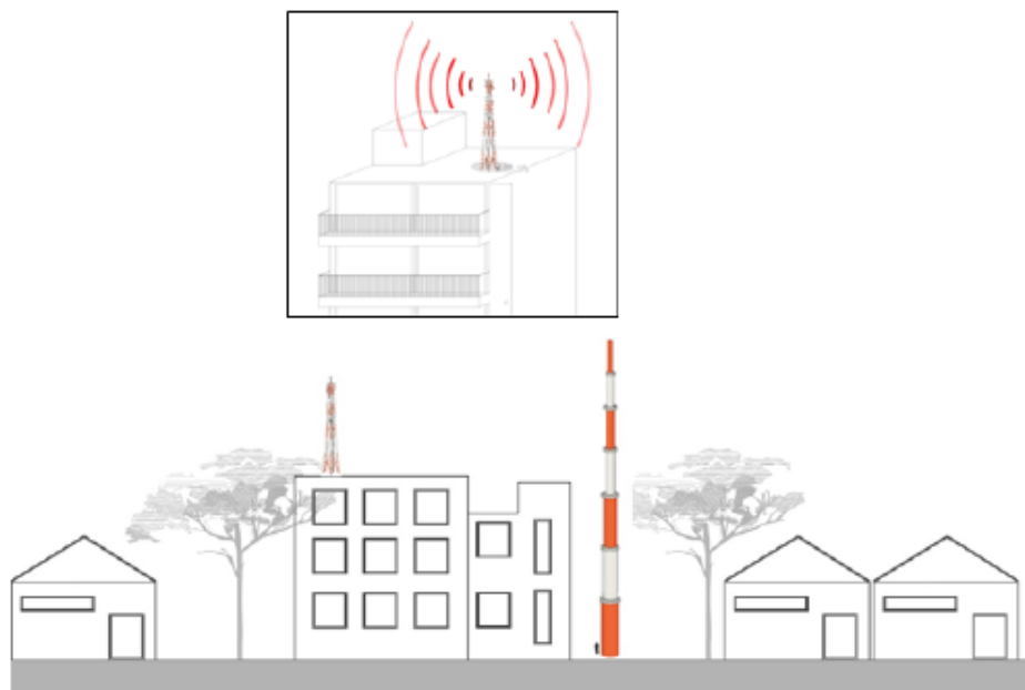
Ilustración 3. Estructura en azotea y torre auto soportada
