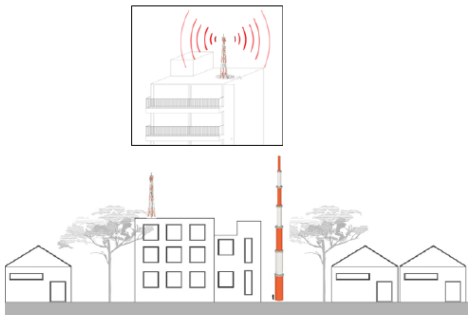
Ilustración 3. Estructura en azotea y torre auto soportada
