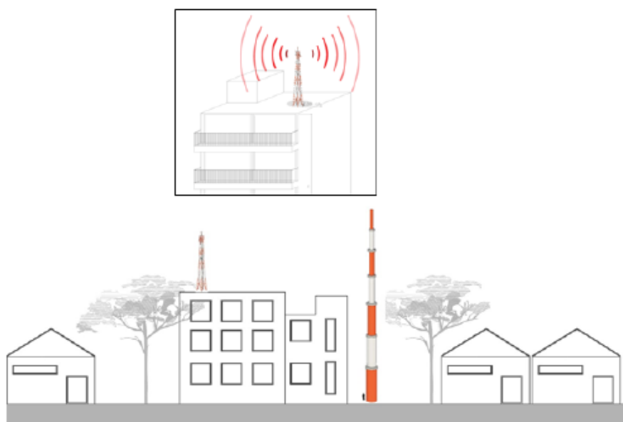
Ilustración 3. Estructura en azotea y torre auto soportada
