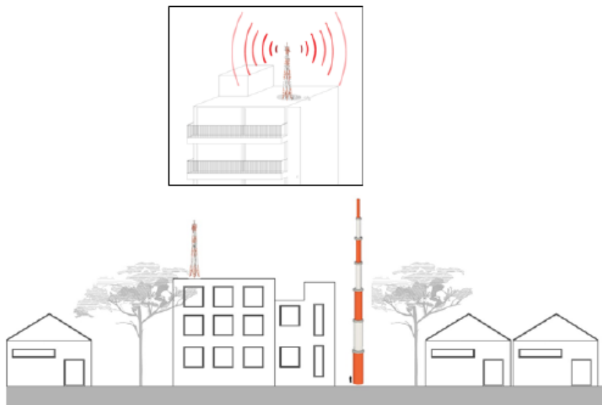
Ilustración 3. Estructura en azotea y torre auto soportada
