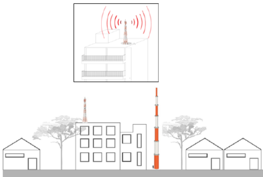
Ilustración 3. Estructura en azotea y torre auto soportada
