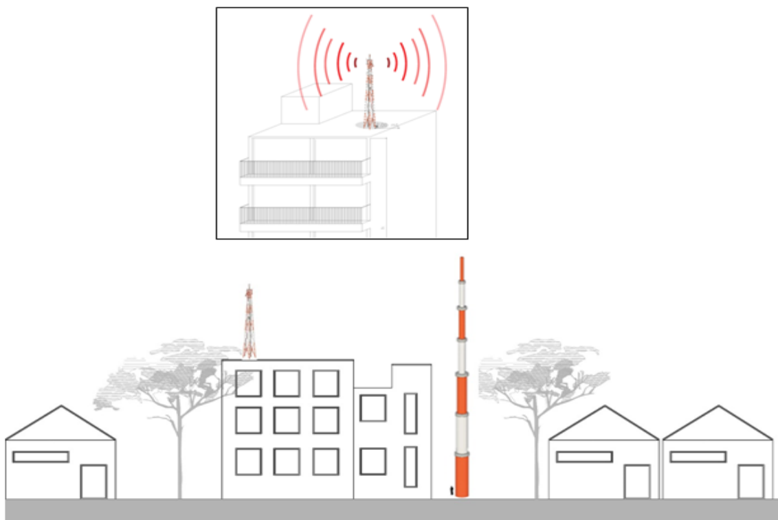
Ilustración 3. Estructura en azotea y torre auto soportada
