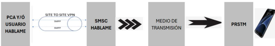
Gráfica 2. Diagrama topológico suministrado por HABLAME del flujo de los mensajes SMS extremo a extremo encaminados a la red de los PRSTM.
