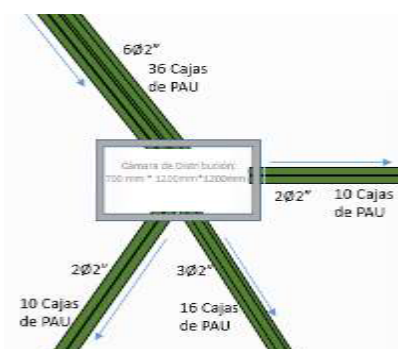
Imagen 1. Cámara de distribución de dos giros
