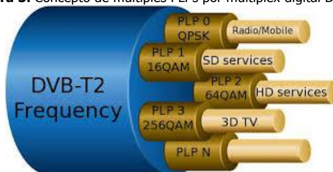
Figura 5. Concepto de múltiples PLPs por múltiplex digital DVB-T2.
