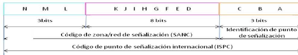
Figura 15: Estructura de los códigos de punto de señalización internacionales
