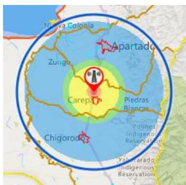
**Ilustración 19. Área de servicio de la estación de radiodifusión sonora en Frecuencia Modulada**
