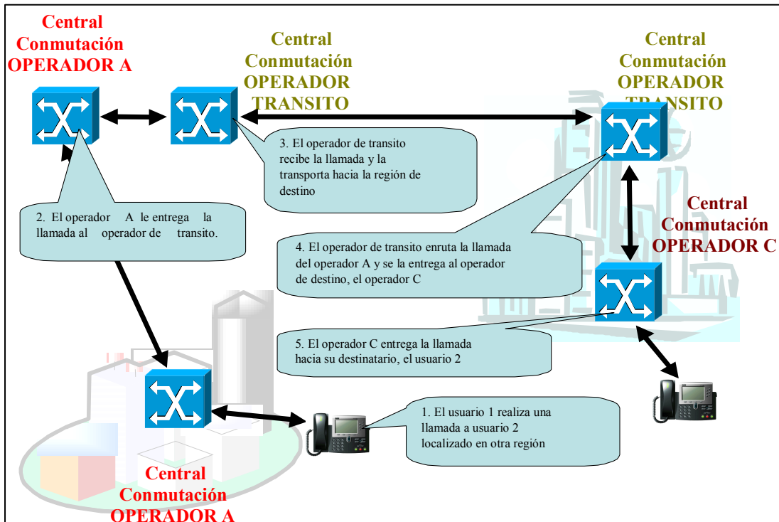
Gráfico 1. Funcionamiento Interconexión Indirecta
